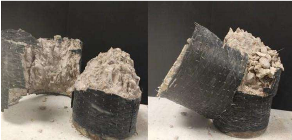
Figura 2. Rotura de algunas probetas confinadas
