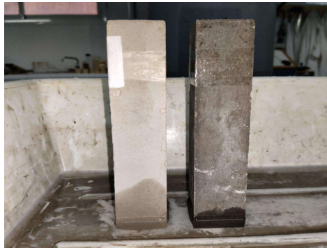
Figura 4. Ensayo de ascensión por capilaridad en muestras de diferente dosificación.
