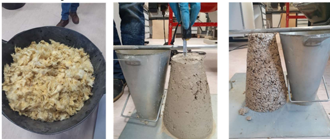
Figura 3. Hormigón con RCDCon y lana de roca. Ensayo de asentamiento al 5.0 y 15.0%
