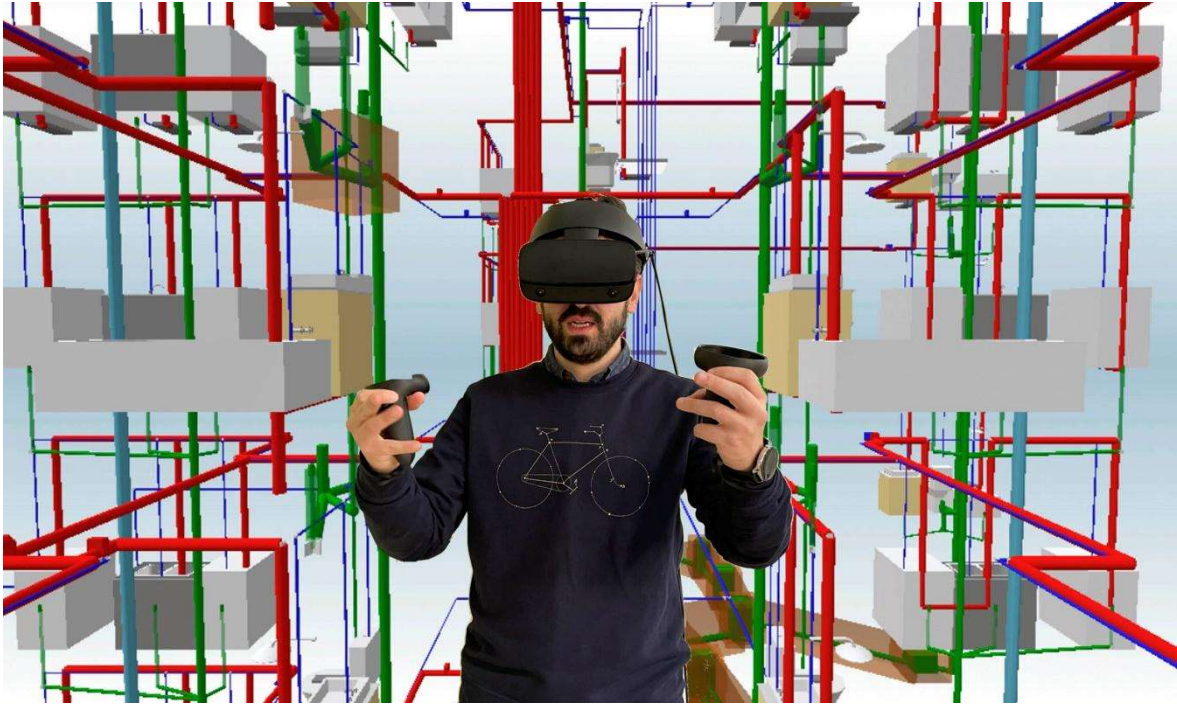
Figura 5. Imagen ficticia de una experiencia VR en el entorno BIMserver de CYPE: inspección de redes hidráulicas.
