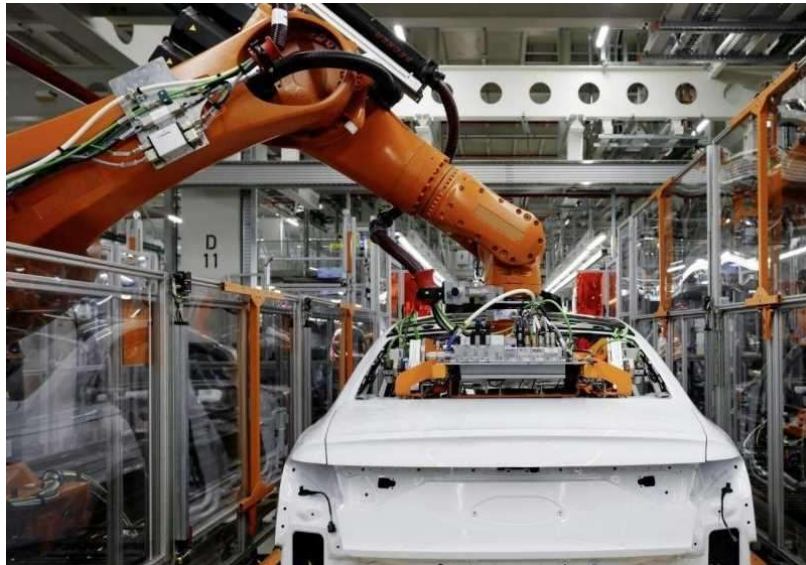
Figura 2: Fabricación de un automóvil por control numérico de un robot de montaje, que recibe los datos directamente desde el modelo digital 3D
