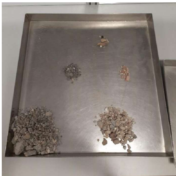
Figura 1. Fracciones en zahorra artificial de RCD de hormigón estructural RCD Con Fuente: Elaboración propia (2022)
