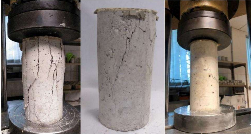
Figura 1. Probetas de hormigón después del ensayo a compresión y antes de ser confinadas
