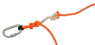
Figura 6: Fracaso del espécimen en la Prueba 10 Fuente: Elaboración propia
