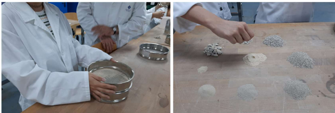
Figura 2. Análisis granulométrico de áridos: tamices y fracciones obtenidas de cada tamaño de árido.
