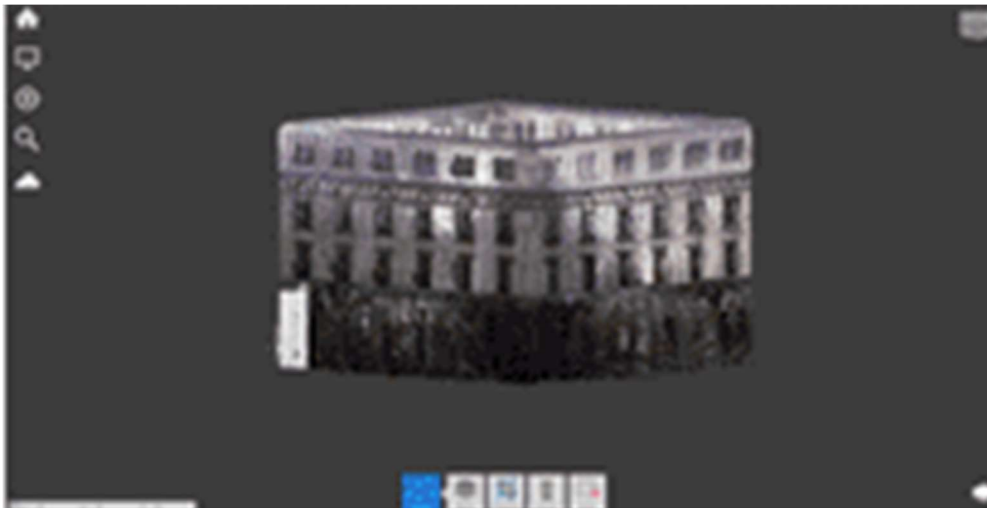
Figura 14. Nube de puntos completa creada en el programa Cyclon Register 360, en formato (.rcp) importada a Autodesk ReCap Pro
