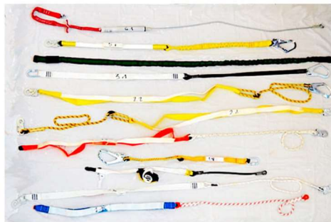
Figura 4: Muestras después de la prueba de rendimiento dinámico
